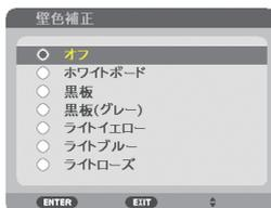
映像を投写する面がスクリーンではなく、部屋の壁などの場合、メニューから壁の色に近い項目を選択すると、壁の色に適応した色合いに補正して投写できます。
