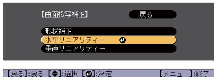
左右方向の伸縮を補正する場合は[水平リニアリティー]、上下方向の伸縮を補正する場合は、[垂直リニアリティー]を選択します。
