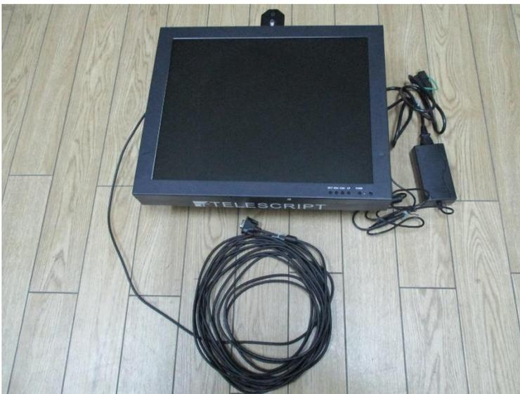
モニター設置後は電源・映像ケーブルの接続が難しくなるため、先に各種ケーブルを接続し、床に設置します。
