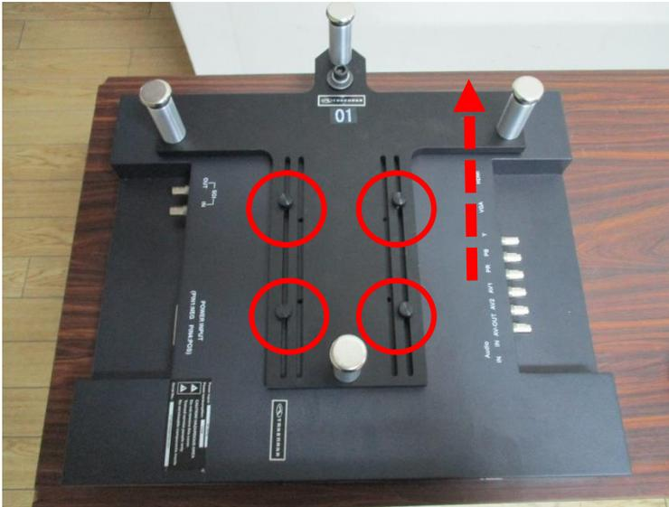
床に設置する前に、モニター裏側の○部分のネジを緩め、足のついた金具を上方向へスライドさせます。
